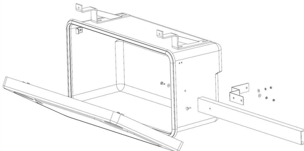
5. Montage des Winkels am Unterfahrschutz und der Staubox.
